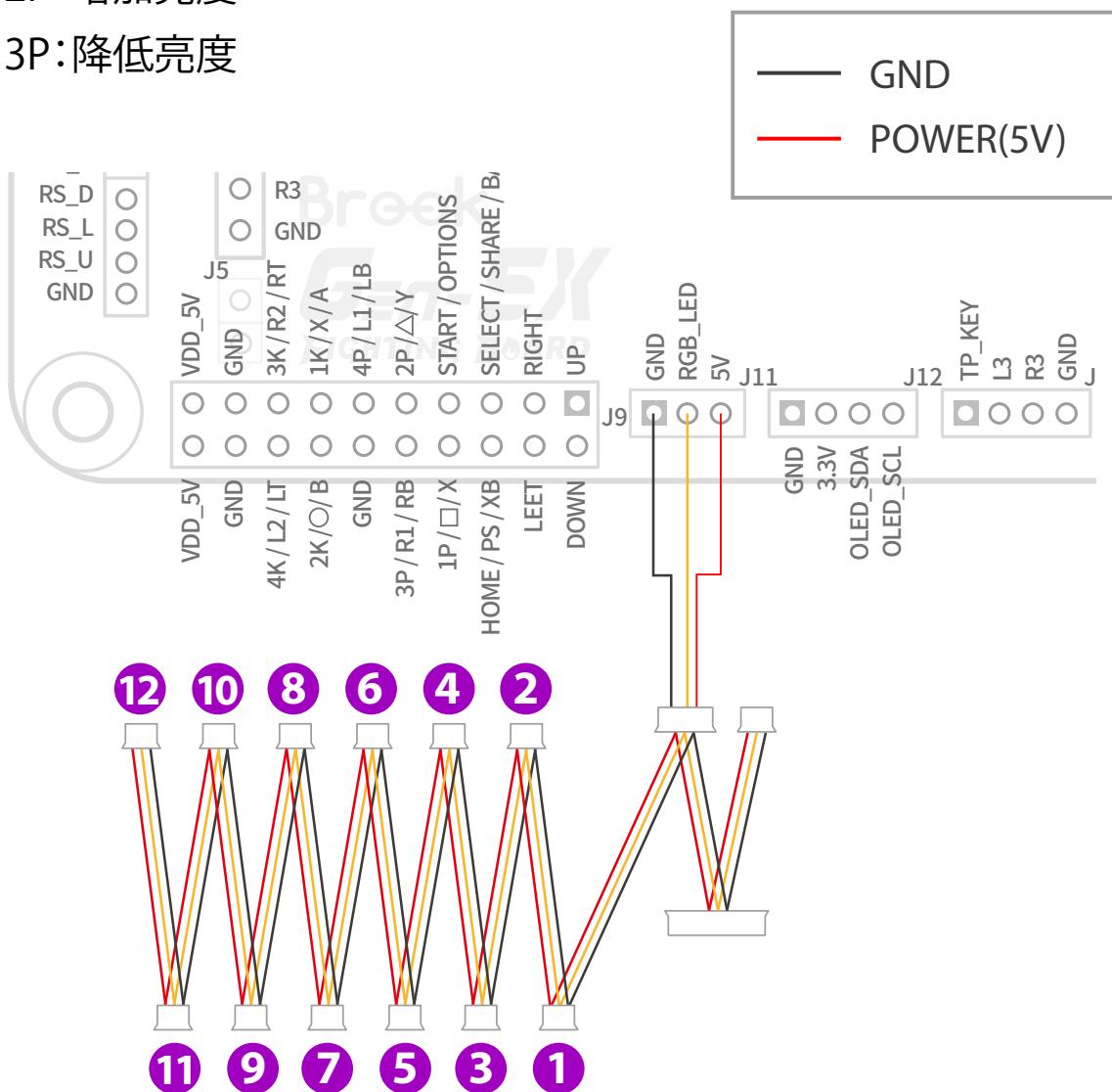
\*按鍵RGB燈光的照明順序將遵循布線順序。例如，第一個連接將編號為1，依此類推。
